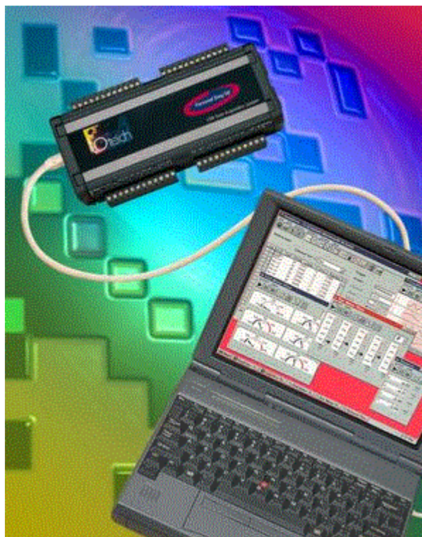
Figura 7: Instrumento virtual utilizando USB (IOTech, 1998)
